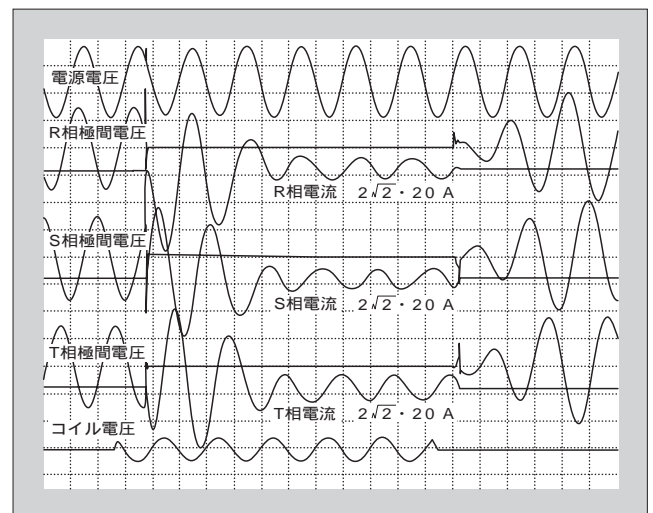
図2 かが形モータを始動、停止した場合のオシログラムの例
