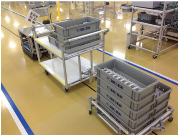
AGV（無人搬送車）による自動搬送
