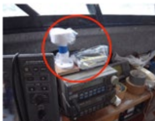
写真1 漁船キャビン内のGPSデータロガー (GPS受信ビーコン、信号処理装置、携帯通信アンテナ)
