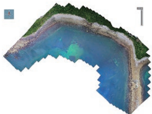
写真-2 オルソモザイク処理で作成した画像
