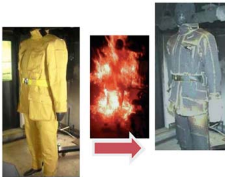
図3 開発したナノテク防火服のサーマルマネキン試験写真(左)及び結果に基づく従来品と開発品の比較(右)
