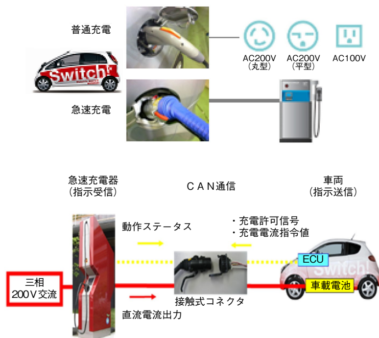
図1 急速充電設備の仕組み
