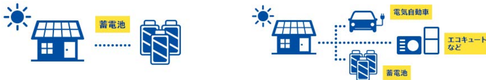
図 4-42 蓄電池の活用例（例：太陽光発電で発電した再生可能エネルギー電力の充電）
