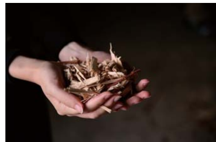
端材は粉碎し木材乾燥機の燃料に(灯油から代替) 丸太一本分すべてを活用
