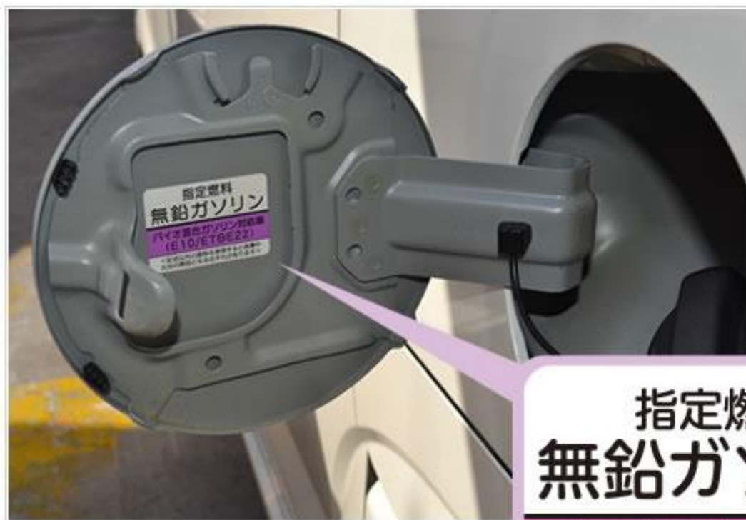
図 2-35 国土交通省の型式認定を受けた E10 対応自動車の給油口に自動車メーカーが貼付したラベル
