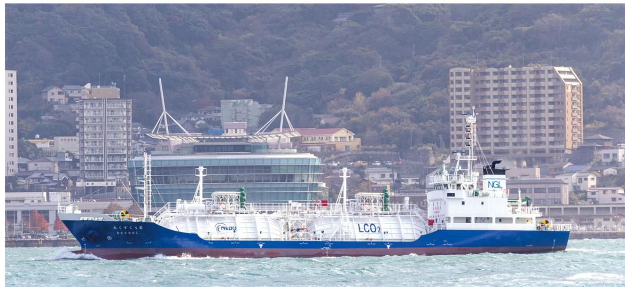
写真1 液化CO<sub>2</sub>輸送実証試験船「えくすくうる」(提供: NEDO及び山友汽船株式会社)
