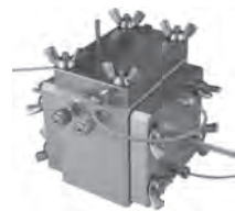
(株)イーシーフロンティア製 電池評価用ガス分析セル
