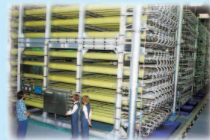
海水淡水化施設の心臓部に当たる逆浸透膜設備
