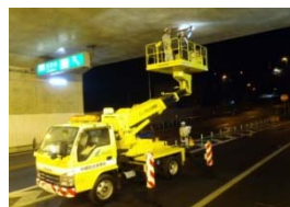
トンネル点検車
