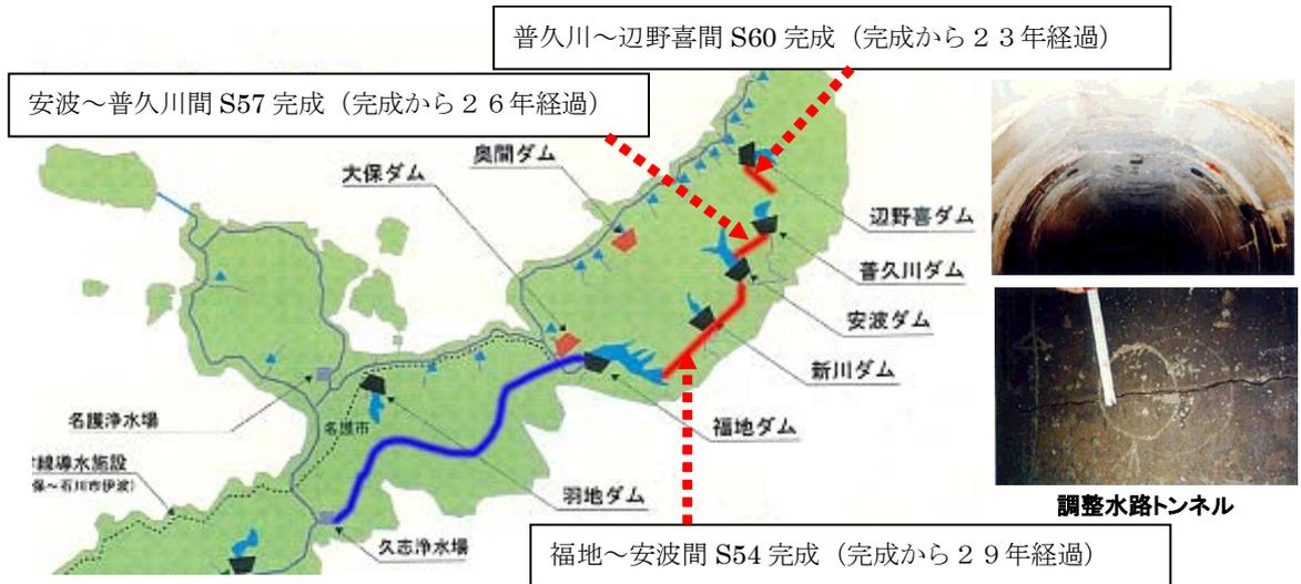
・河川特性上、**厳しい水の利用条件**にある沖縄では、**ダムをつなぐ調整水路トンネル**により、**効率的な水利用のシステム**を構築。
