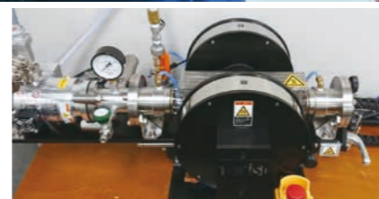
磁気特性を改善するための磁界中熱処理装置
