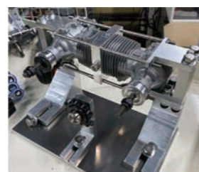
小型車やハイブリッドドローンへの搭載および災害時非常電源を想定した超小型・無振動・2ストローク対向ピストンエンジン式発電パワーユニットの開発
