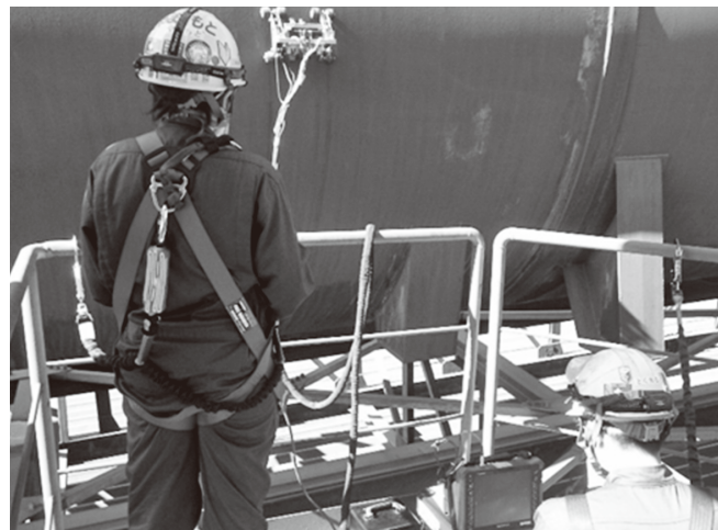
側面を自走測定する独自のRFスキャンシステムを開発
