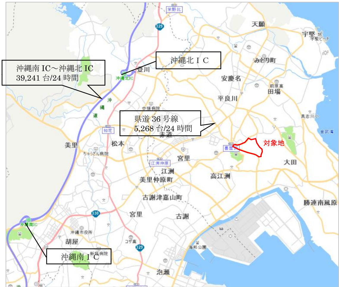
図 3-3 沖縄自動車道、県道 36 号線の交通量
