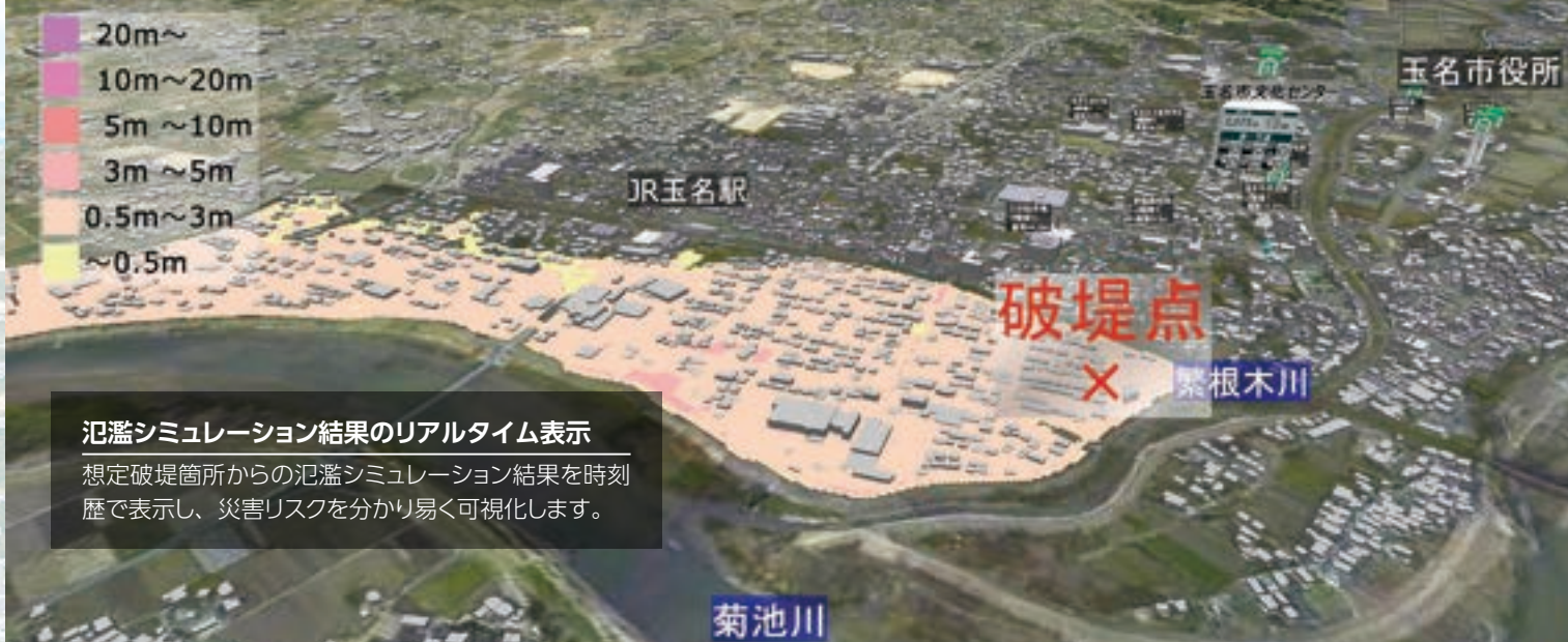
▲玉名駅周辺が最大浸水深となる繁根木川の氾濫シミュレーション結果の可視化(浸水深表示)
