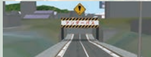
▲アンダーパス部分に警告の表示を配置
