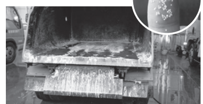
▲ ごみ収集車内で破裂したマイクロビーズ
