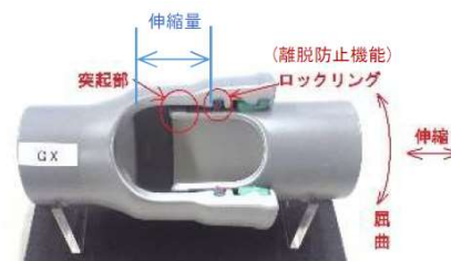
耐震管継手構造
