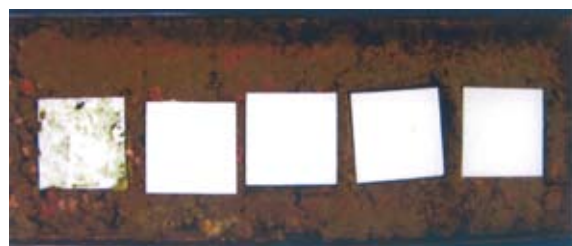
左以外、同社高機能性抗菌塗料を使用。 カビの発育が全く認められない。
