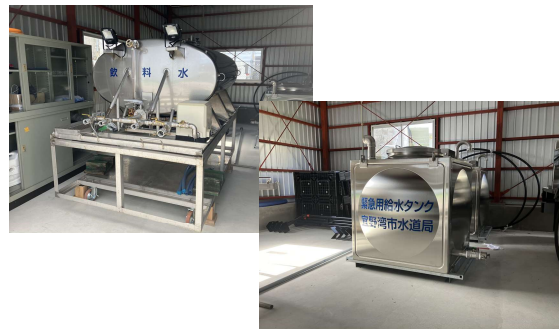
応急給水タンク【上：1.6 t(m 3 )、下：1.0 t(m 3 )】
