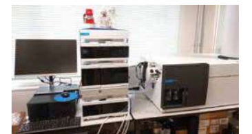
ARIMで導入された機器 液体クロマトグラフ質量分析器(LC-MS)
