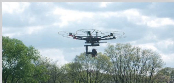
空撮 (UAV) による写真測量 Photogrammetry by using aerial images (UAV)
