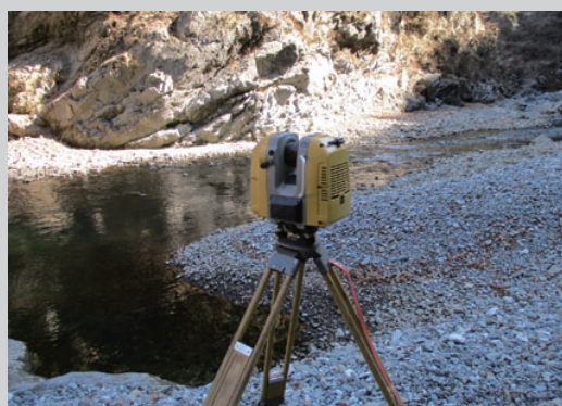
地上型レーザー計測機による三次元測量 3D survey using laser measurement
