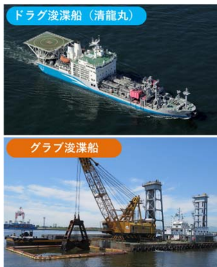
図-12 ドラグ浚渫船(上)とグラブ浚渫船(下)
