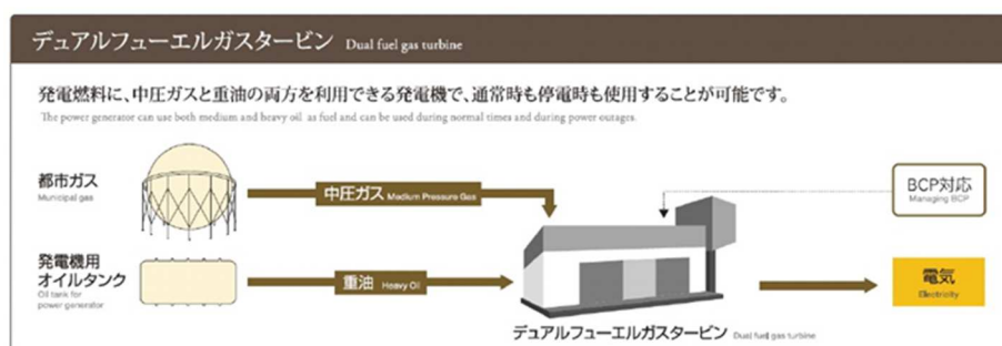
▲非常用発電用ガスタービン
