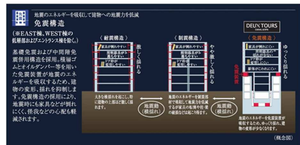
▲同マンションの免震構造
