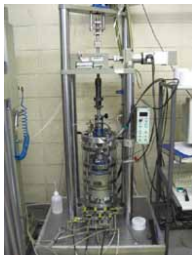
左：研究で用いた液状化試験機。 右上：地域の方を対象に行った液状化に関する講習会の風景。小さな子どもに液状化実験を実演している場面。 右下：液状化被害実地調査をした際の写真。液状化によるマンホールの浮き上がり。
