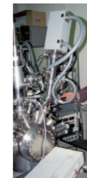
■電子・イオンデュアル収束ビームを用いた微小領域三次元分析のための試作装置。直径数マイクロメートル以下の微粒子や材料の微小領域を、収束イオンビームを用いて三次元加工を行いながら収束電子ビームを用いて高感度分析を行う。これにより、固体内部の三次元元素分布を0.1マイクロメートル以下の分解能で明らかにすることができる。 Prototype instrument for three-dimensional analysis of small objects by electron and ion dual focused beams.
