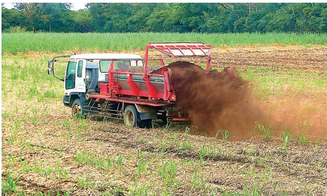
写真5 マニュアルスプレッダーによる牛ふん堆肥の散布（北大東製糖提供）
