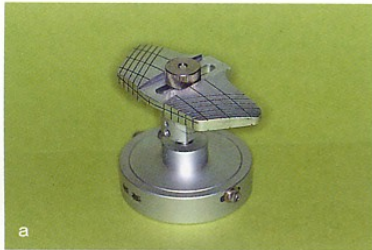
図20a,b 咬合湾曲面診断・設定器具 SHILLA III。SHILLA III は、モンソンの球面説から引用した半径 4 inch(10cm)の球面盤に正中要素を採り入れ、咬合器上弓に取り付け、下顎模型咬合平面に対して湾曲面的所見からの診断・構築を目的としたものである。SHILLA II 同様の昇降機構、矢状傾斜機構、前後スライド機構などを有し 9 、すべての臨床模型への対応が可能である。
