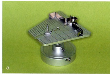
図19a,b 咬合平面診断・設定器具 SHILLA II。SHILLA II は、多くの咬合器でみられる咬合平面盤に似たものと考えてよく、正中に上顎模型正中矢状面を合致させて支持し、咬合器付着が行われる関係上、盤部と模型支持部とから構成される。基準盤は、最低値49mm、最高値60mmの上下昇降調節・固定機構、 \pm 30^\circ の矢状傾斜可変・固定機構と個々の ABE 咬合器上で正中矢状面を確実に合致させるための矢状的正中調節・固定機構が備えられており 9 、すべての臨床模型への対応が可能である。
