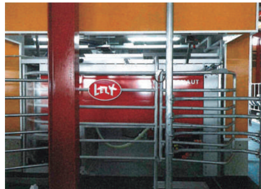
搾乳ロボットの導入により、省力化が図られ、生乳生産量の増加や、経営所得の向上につながった
