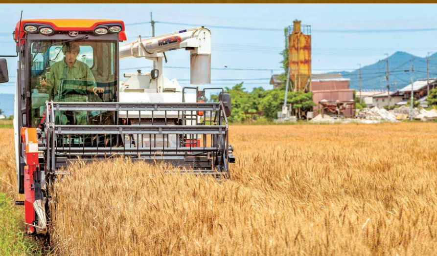
小麦を刈り取り、脱穀、麦わらをカットして選別するまで、すべてこのコンバインハーベスタが行います。
