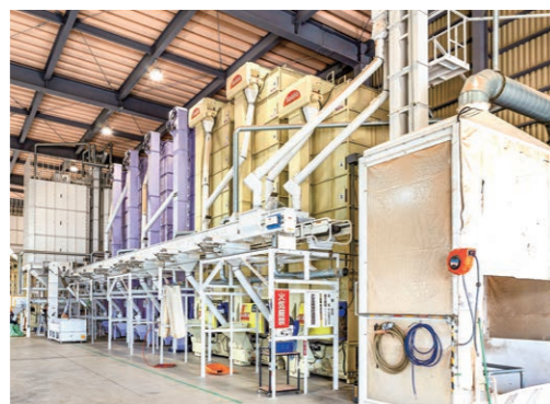
収穫した小麦はここに運ばれ、機械の中で風と熱を循環させて、まず乾燥させます。風を当ててゴミなどを飛ばしたら、メッシュに通して粒の大きさを選別していきます。
