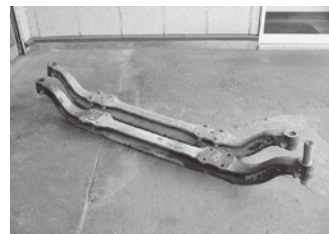
フロントアクセル修理
