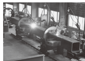
柱大組立溶接ロボット 20t
