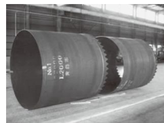
下水道立杭ケーシング
