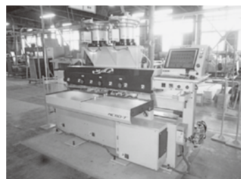
ボーリングマシン
