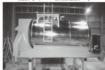
飲料水輸送用タンクローリー製作
