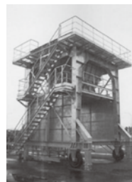
八戸港湾向ポータブルホッパー設備
