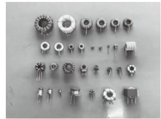
トロイダルコイル各種の巻き線加工
