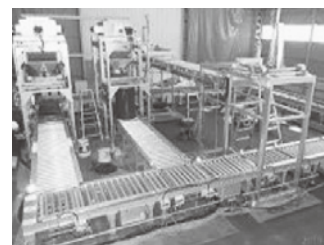
震災焼却灰ドラム缶自動充填装置
