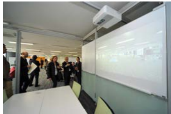
プロジェクトブース：短焦点のプロジェクタとすることで投影面近くの人も影にならない
