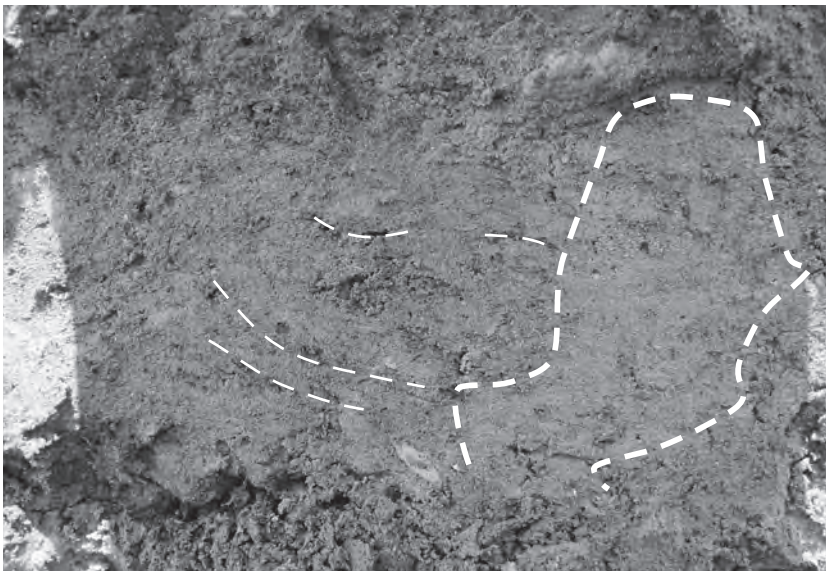
第131図 遺跡の東壁に露出している砂層の写真。下の写真には解釈を加えている。写真中央下部の橙色の部分は腐食を免れた木片。そのすぐ左側には、茶色の炭質物の濃集したごく薄い層が右上から左下にたいへん緩い傾きで傾く様子が見られる。写真右半分の部分に炭質物が見られない砂の部分がある（点線で取り囲んだ部分）。これは下から、液状化した砂が入り込んだものと推定される。細い点線は堆積構造の一部をトレースしたものの。
