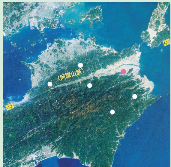
第1図 観測点配置(赤丸は観測所本館、白丸は衛星観測点)と中央構造線の位置(二つの矢印で挟まれた地形)【衛星写真は、(株)阪神コンサルタンツより提供】
