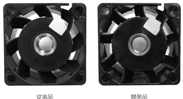
図5 開発品と従来品のフレーム形状の比較
