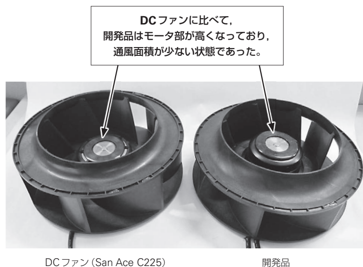
図7 開発品と DC ファンの動翼の比較
