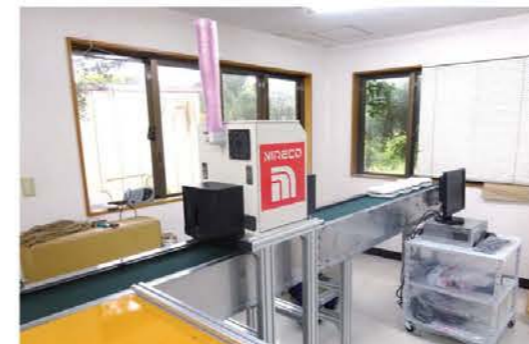
非破壊糖度センサー付き選果機
