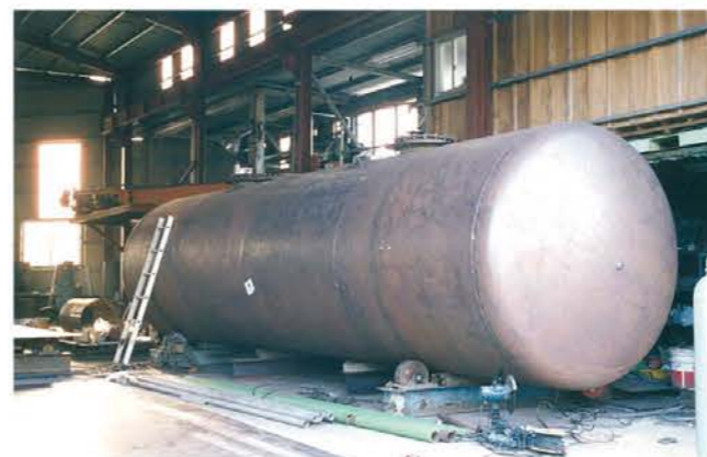
地下埋設燃料タンク30kℓ
