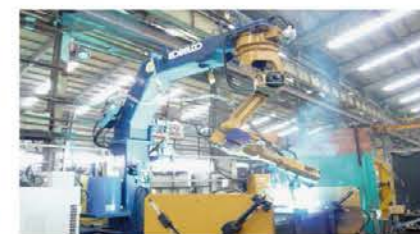
工場加工機械設備 鉄骨天吊りロボット
