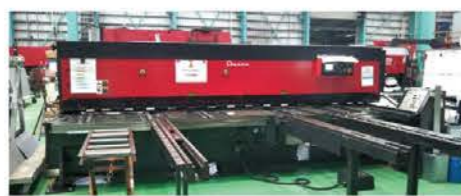
2019年8月新設アマダ製メカニカルシャーリングマシンM4065リターンショットコンベア付
