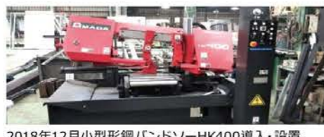
2018年12月小型形鋼バンドソーHK400導入・設置
