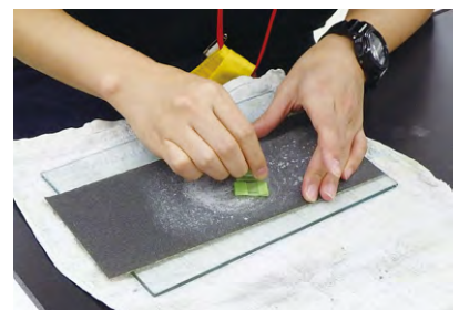
図5. スライドガラスに貼りつけた後、#80の紙やすりで磨く。養生テープでつまみと片減り防止がしてある。
