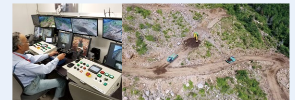
AI制御による不整地運搬車(クローラキャリア)の自動走行技術
