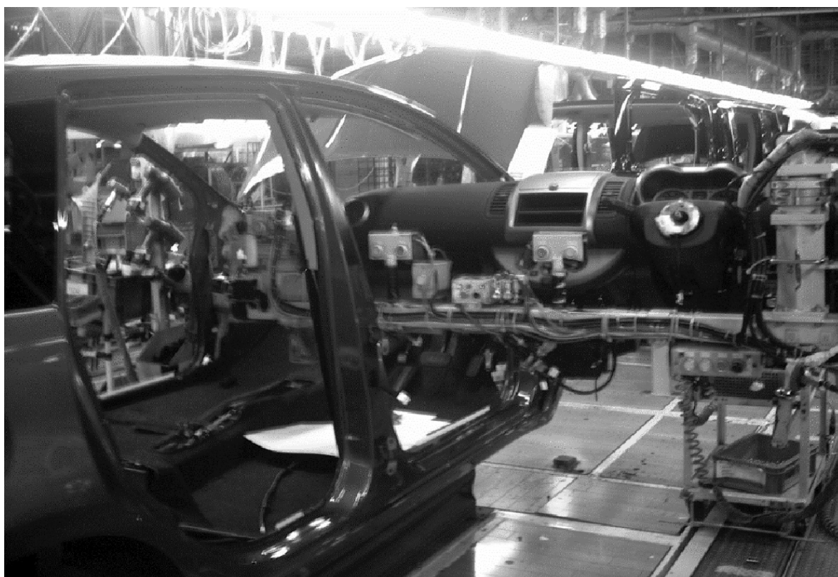
図3 「順序生産」したコックピットの車両搭載
