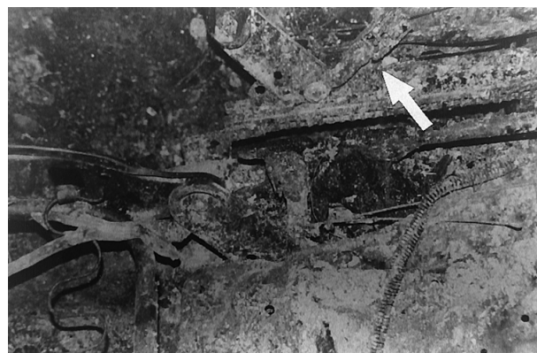
図12 燃焼した座席ベルト(矢印)
