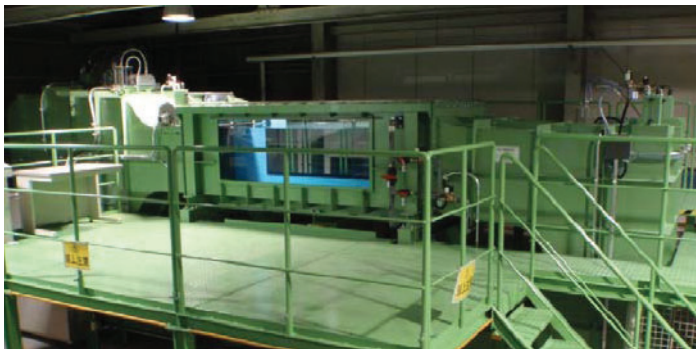
縦型回流水槽(西日本流体技研:V2-20B)
