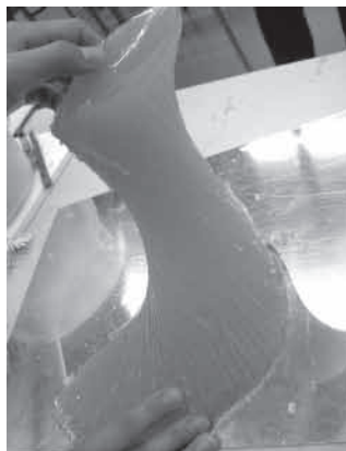
HP 曲面型枠で作られた寒天のポリウム
