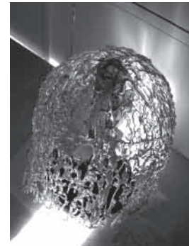
構造だけでなく質感もガラスに近く、光の透過や反射も検証できる
