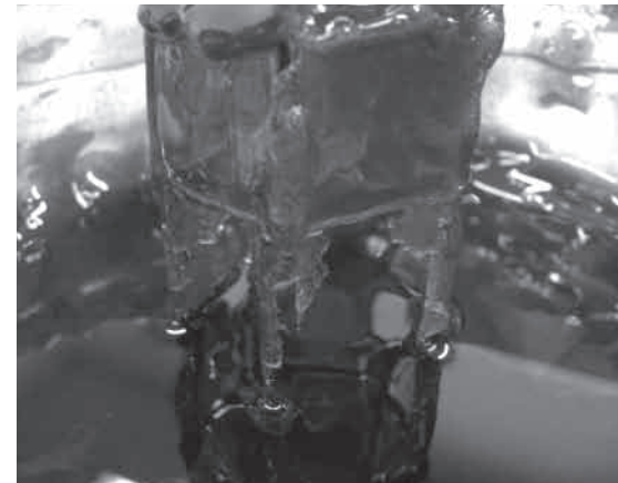
水と空気に解け、崩壊寸前のタワーの脚元。どこまで構造を削ぐと壊れるか体感的に理解できる
