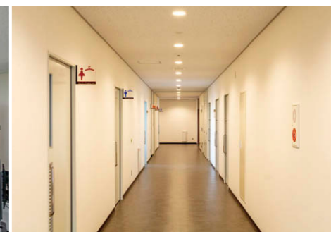
廊下 ストレス軽減効果を考慮し 3500K 温白色の LED ユニット交換形ダウンライト③を採用。
