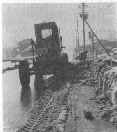
写真-10 除雪グレーダのブレードによる歩道除雪
