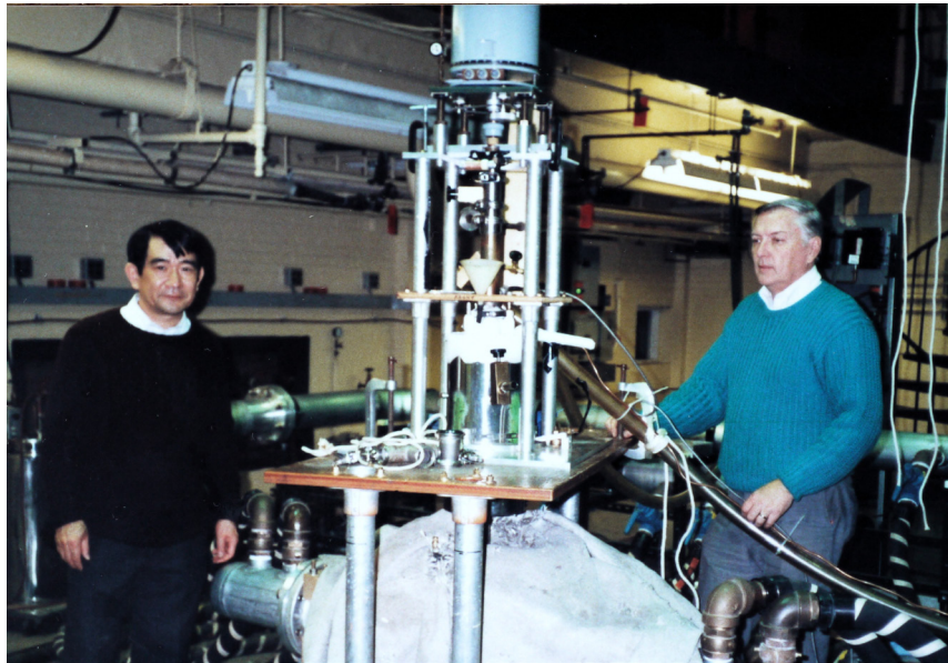
写真: ビッター型水冷マグネットと 3 He VSM. 写真左は三浦先生. 1989年1月27日, MIT-FBNMLにて筆者撮影.
