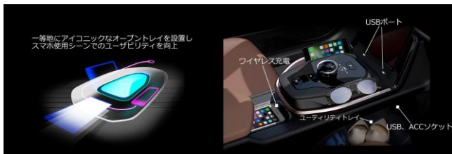
図11 スマホ使用シーンに便利なトレイ型のコンソール “デジタルアイランド”
