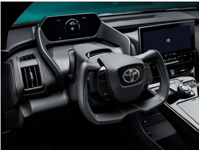
図12 ステアバイワイヤの 異形ステアリングホイール仕様
