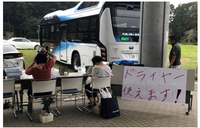
図3 FCバスからの給電でドライヤ5台使用
