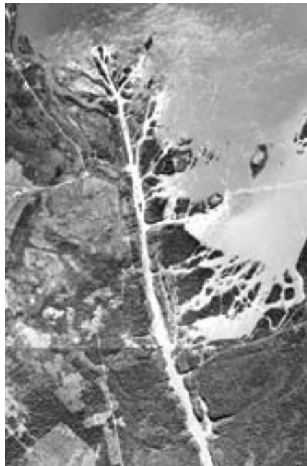
Fig. 16 - Foto aérea das cachoeiras de Sete Quedas, ilustrando o controle estrutural das quedas transversais ao canal principal (Aerodata, 1963)
