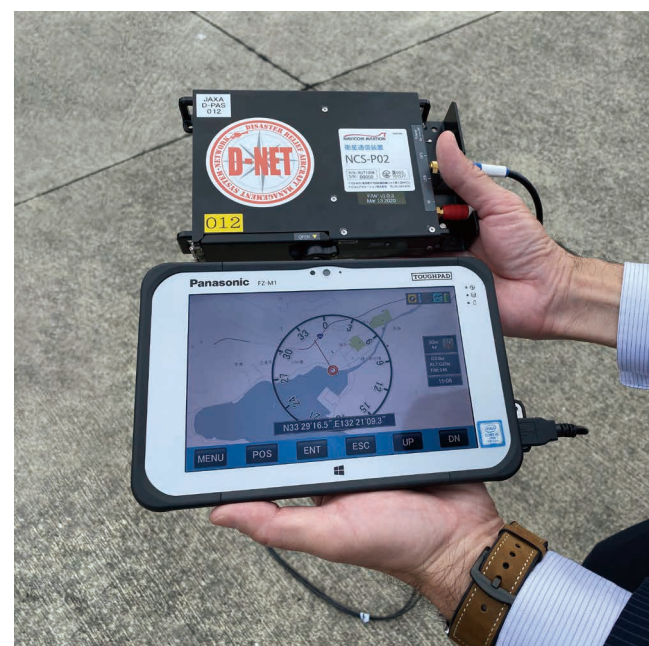
タブレットのテスト機。赤い円が現在地であり、機体が動き始めると矢羽のマークに変わり進行方向を示す。
