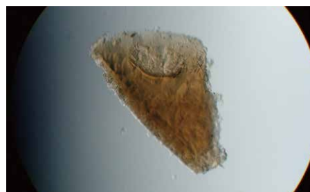
⑥ 「たんぼぼ」計画で地球低軌道から回収された宇宙塵衝突痕。直径1mm未満の微小クレーター。
