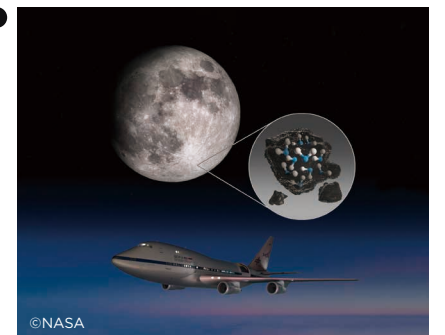
「SOFIA」は飛行機に赤外線望遠鏡を搭載した“飛行天文台”。ボーイング747-SPジャンボジェットを改造してつくられている
