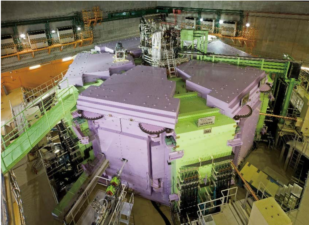
図 7-11 RI ビームファクトリー超伝導リングサイクロトロン
